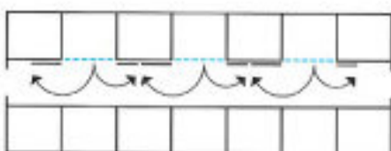
Stalschema met in 2 delen wegdraaibare voorwanden
