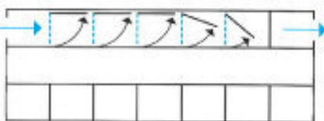
Stalschema met wegdraaibare tussenwanden
